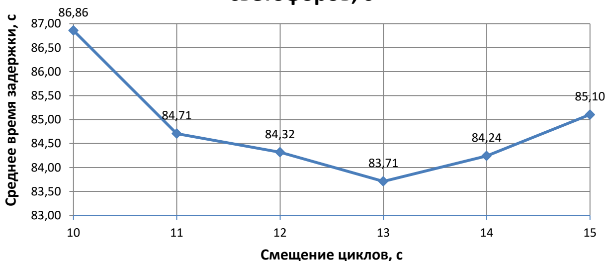
Рисунок 21 – Изменение времени задержки (с) в зависимости от смещения фаз светофоров
