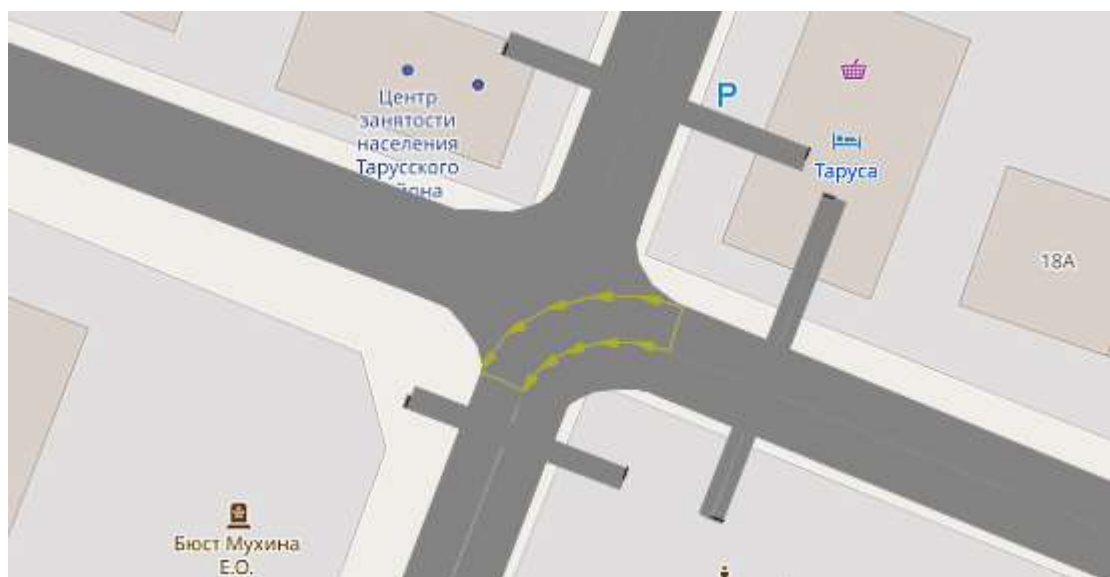
Рисунок 12 – Соединяющий отрезок для поворота налево
