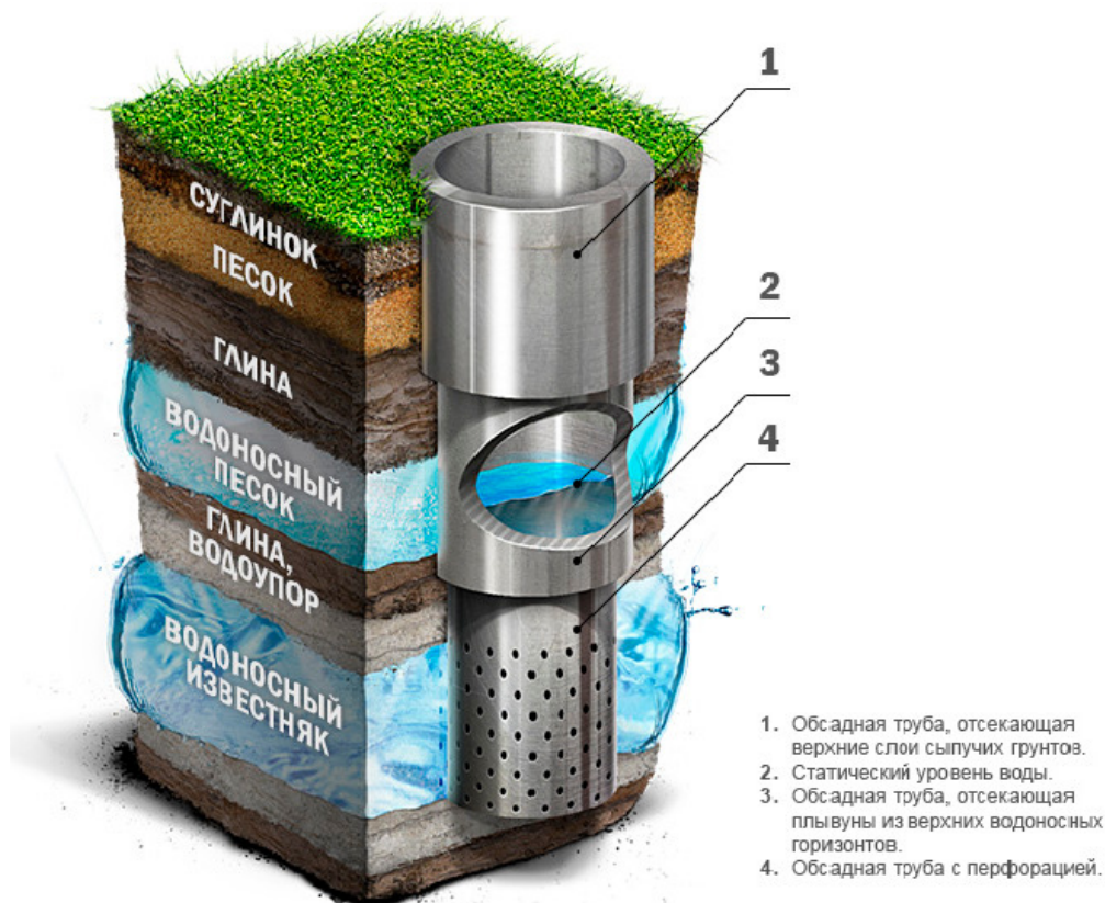
Рис. 4.1. Конструкция артезианской скважины
