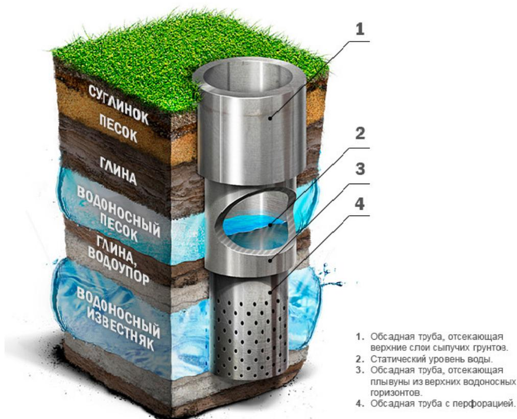
Рис. 4.1. Конструкция артезианской скважины
