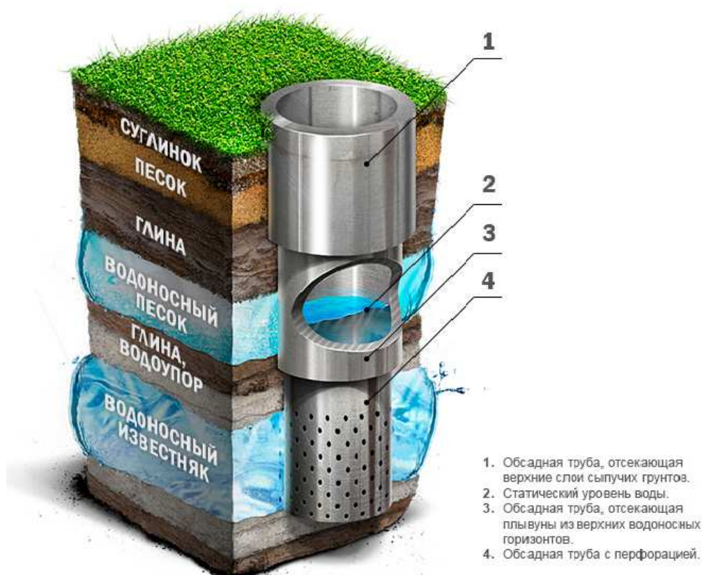
Рис. 4.1. Конструкция артезианской скважины
