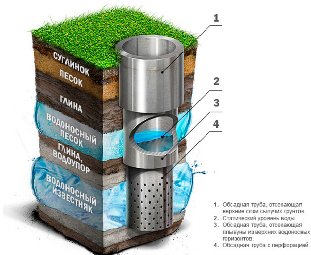
Рис. 4.1. Конструкция артезианской скважины
