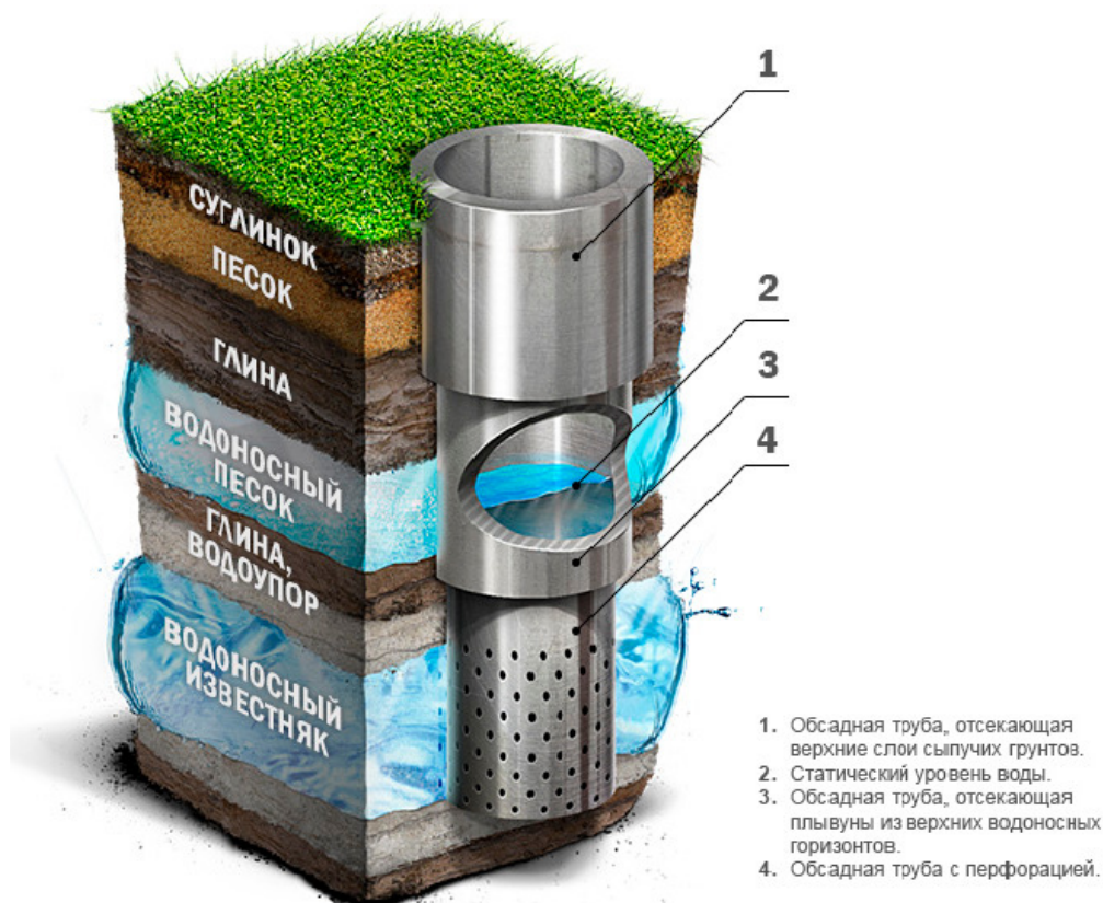
Рис. 4.1. Конструкция артезианской скважины
