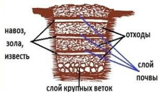
СХЕМА КОМПОСТНОЙ ЯМЫ
